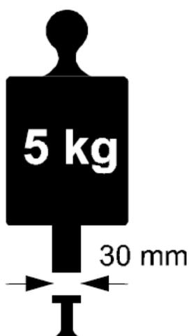
此儀器用於測量服裝和鞋的厚度，需能測量到十分之一公厘(0.1 公厘)。測量時在測量儀上施加 5 公斤的重量。測量儀有兩個直徑為 30 公厘的圓形平面板，面與面對。
